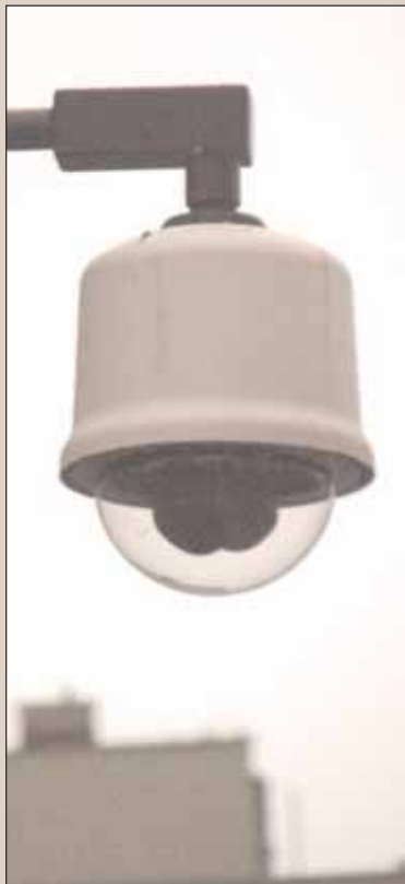
■ Jedna z 16 nowoczesnych kamer szybkoobrotowych zainstalowanych na słupach na terenie osiedla
